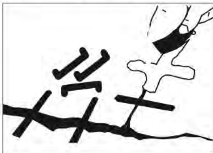
Рис. 3.3 Наложение скоб на стяжку и закрытие трещин силовым замыканием
