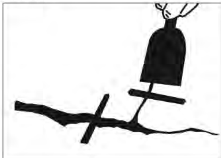
Рис. 3.4 Затирка 2-х компонентной смолы шпателем
